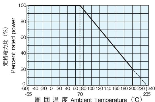
周囲温度70℃以上で使用される場合は、上図負荷軽減曲線に従って、定格電力を軽減して御使用ください。
